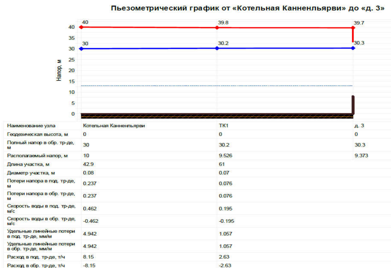
Рисунок 26 – Пьезометрический график котельная п. ст. Каннельярви, котельная ул. Железнодорожная
