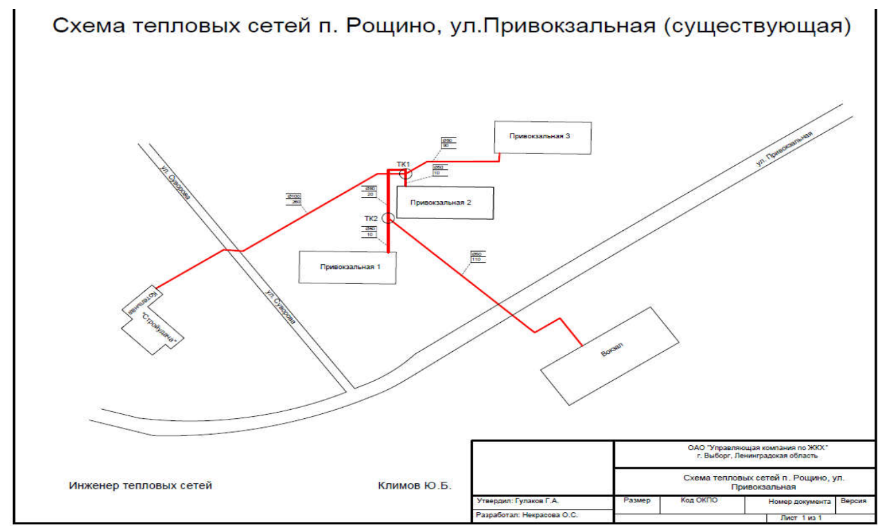
Рисунок 6 Зона действия котельной п. Роцино, ул. Привокзальная
